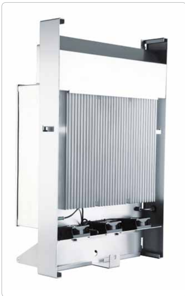
Řešení chlazení na zadní straně měniče - pasivní chladič podporovaný ventilátory spínanými v teplotních špičkách
